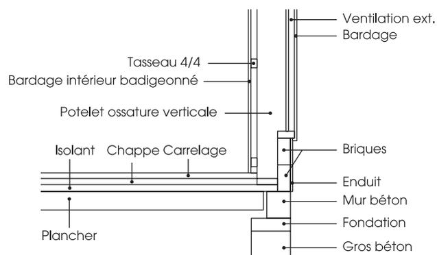
Coupe sur les fondations d'une maison à ossature bois et le raccordement avec la dalle de sol.
